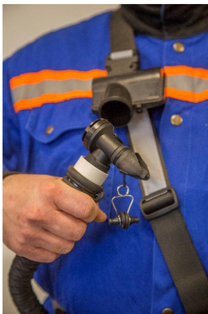
Rys. 6. Uwalnienie ustnika z zaplombowanej obudowy
