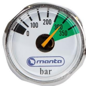
Rys. 2. Przykład prawidłowego położenia wskazówki na zielonym polu
