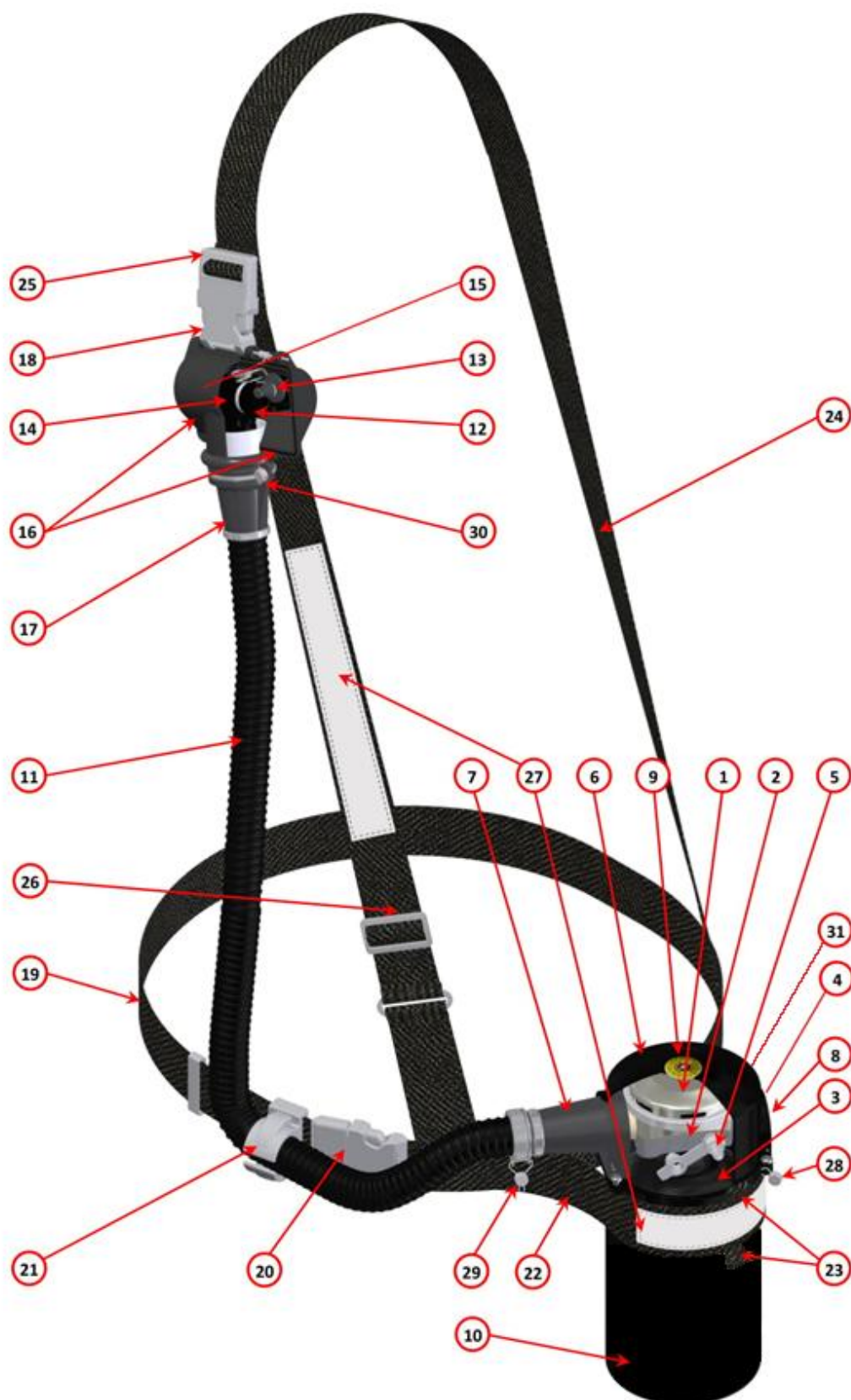
Rys. 1. Budowa uciezkowego aparatu powietrznego butlowego natychmiastowego działania typ MANTA
