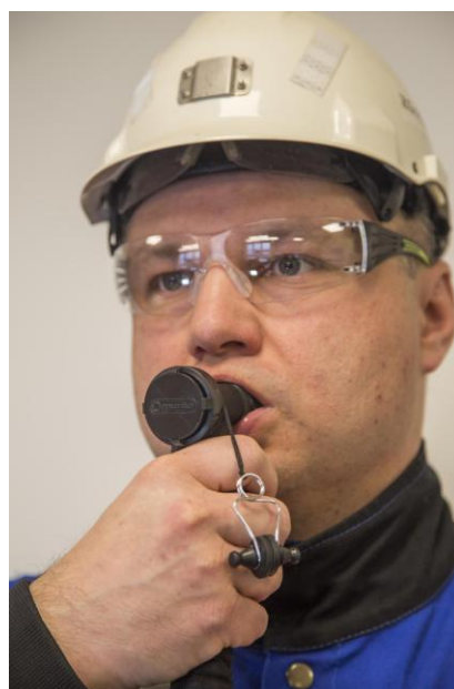
Rys. 7. Włożenie silikonowego ustnika do ust i użycie zaciskacza nosowego
