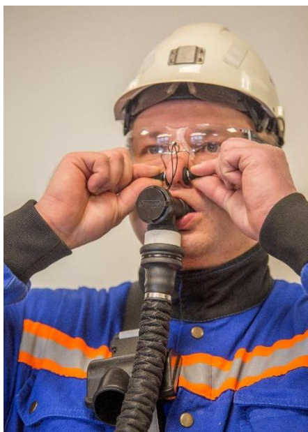
Rys. 8. Poprawnie założony aparat uciezkowy typ MANTA w celu użycia
